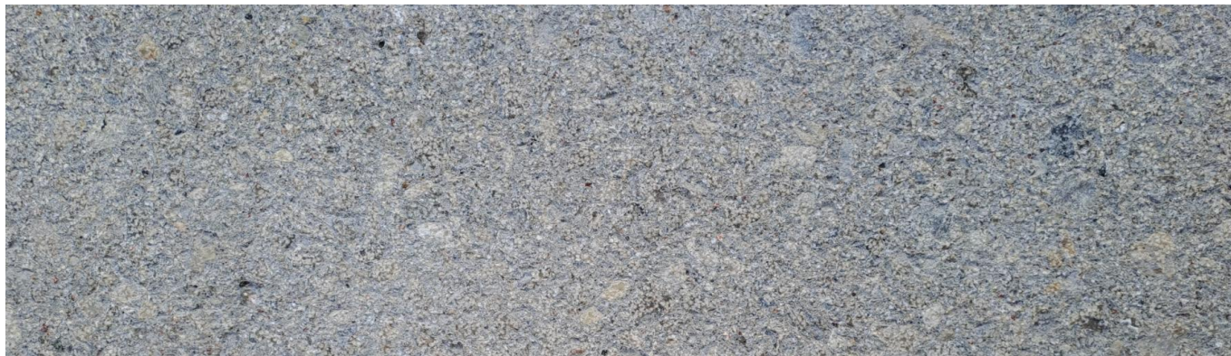
Pav. 21 Šiuokštinto betono paviršiaus pavyzdys
